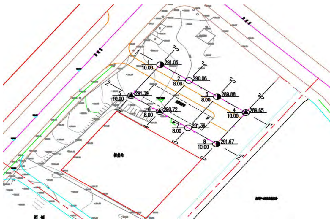
图 3-2 勘探点平面布置示意图
